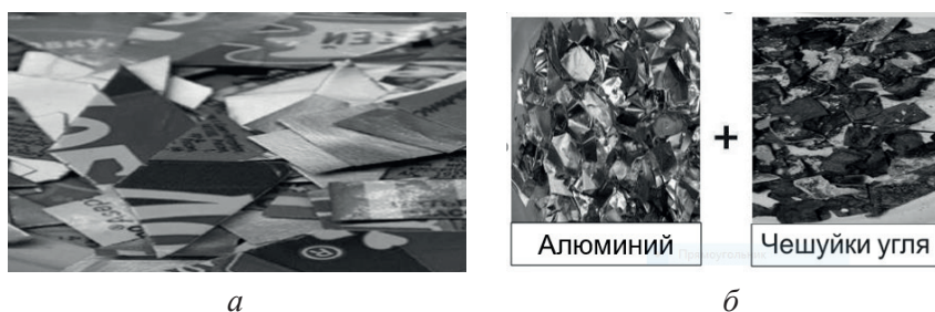
Рис. 7. Упаковки «Тетропак»: а – вид до обработки; б – вид после обработки
