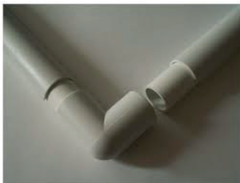
Рис. 2. Соединение переходниками трубчатой рамы
