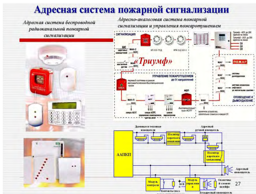
Рисунок 1 – Адресная система пожарной сигнализации
