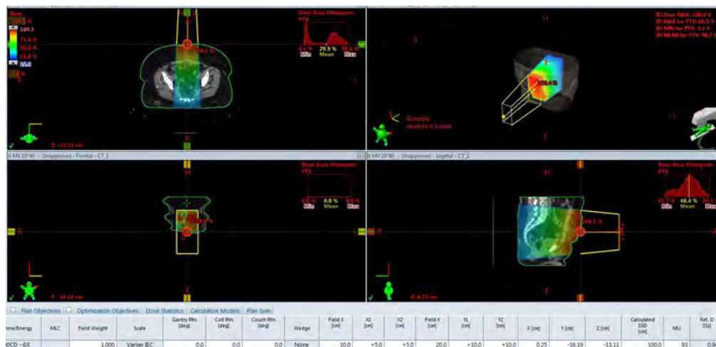
Рисунок 1 – Расчет количества ME для прямоугольного поля 10×40 см на ускорителе Clinac (6 МэВ)
