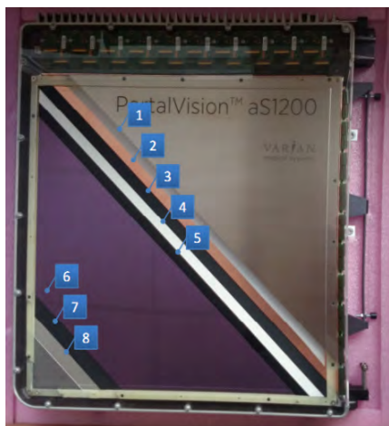
Рисунок 1 – Послойное расположение пластин в матричном детекторе
