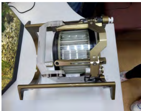
Рисунок 2 – Фантом для оценки геометрического искажения с установленной индикаторной коробкой Leksell, стереотаксической рамкой Leksell G, помещенный в адаптер для головной катушки Siemens, используемый при внутричерепном МРТ-сканировании для планирования СРХ на стереотаксической установке Гамма-нож
