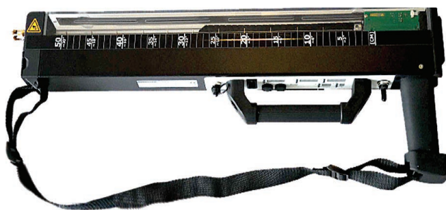
Рисунок 1 – Резистограф научный Resistograph R650-SC
