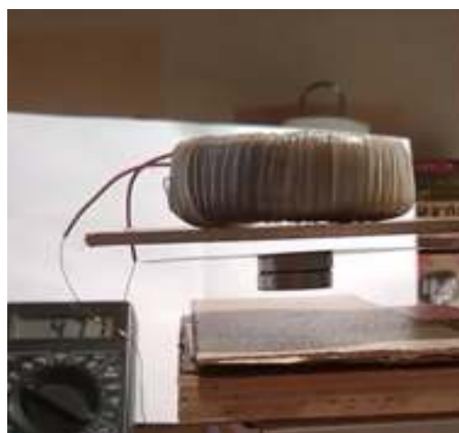
Левитация магнита на итоговой версии установки
