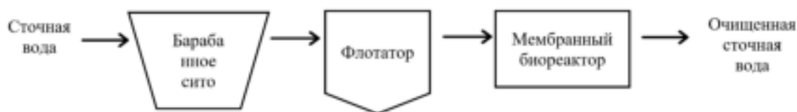
Рисунок 1 – Схема проектируемых локальных очистных сооружений
