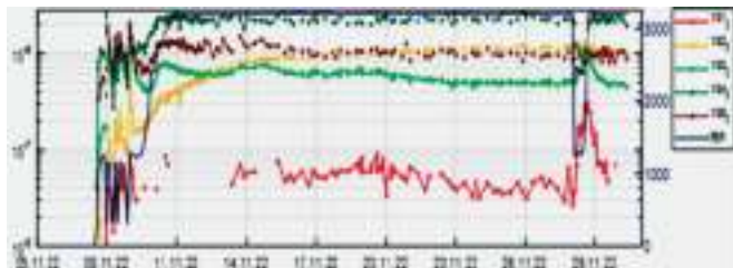
Рисунок 2 – Удельные активности (вертикальная ось слева, Ки/кг) радионуклидов йода в теплоносителе первого контура и тепловая мощность РУ (RP, вертикальная ось справа, МВт)
