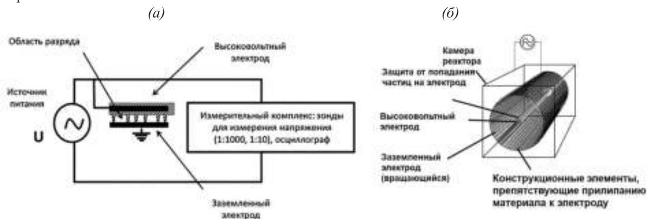
Рисунок 1 – Схема установки для создания диэлектрического барьерного разряда (а) и реактора (б) “Piccolo”
