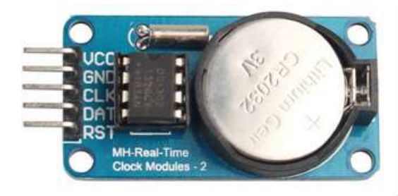
Рисунок 2 – Часы реального времени DS1302
