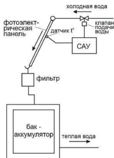
Рисунок 4 – Система охлаждения солнечной батареи
