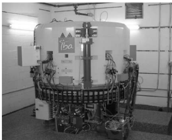
Рисунок 2 – Циклотрон для наработки радиофармпрепаратов
