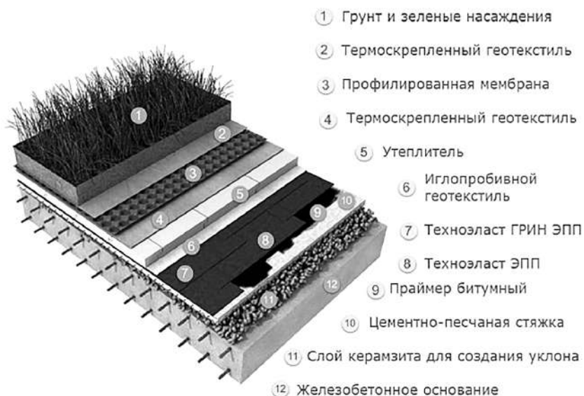
Рисунок – Конструкция «зеленой кровли»
