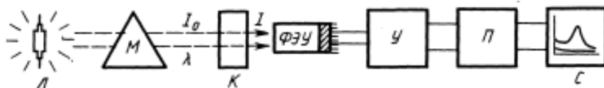
Рис. 2.5. Схема устройства спектрофотометра: источник света (Л); монохроматор (М); кювета с образцом (К); фотоэлемент – чаще всего используется фотоэлектронный умножитель (ФЭУ); блок усилителя фототока (У); регистрирующее устройство (П, С)
